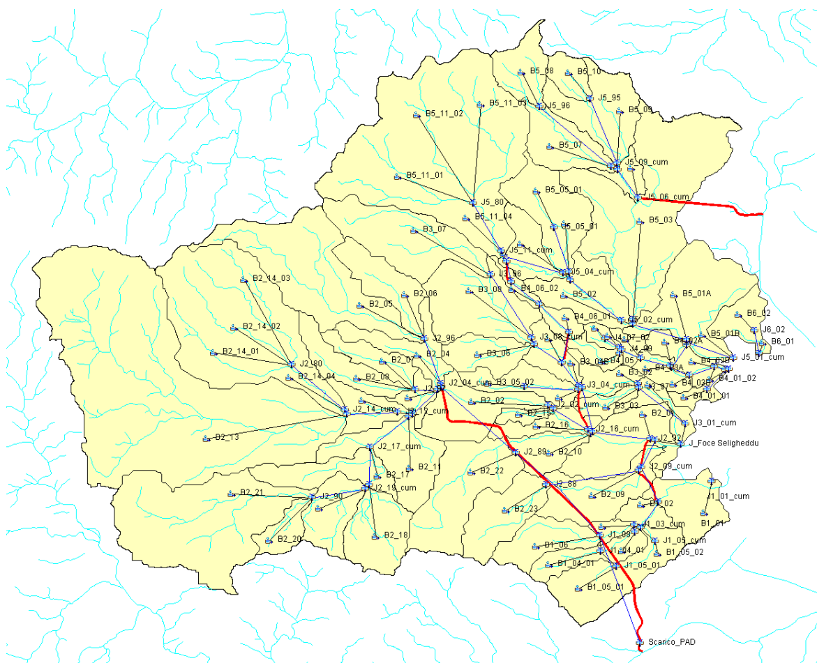
Figura 3.2 - Schema del modello idrologico sviluppato in HEC-HMS. In rosso gli scolmatori e i deviatori di progetto.
